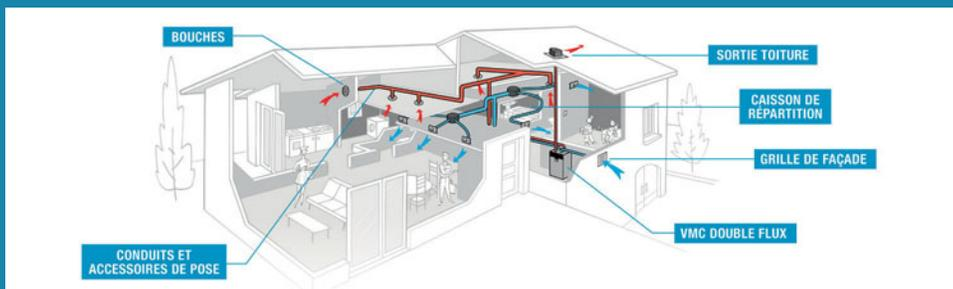
**En hiver**, contrairement à la version simple flux qui introduit de l'air extérieur froid, la double flux récupère les calories de l'air extrait pour le transmettre à l'air entrant qui aura été préalablement filtré.
