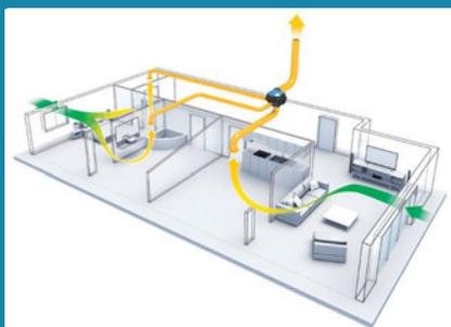
La version de base **auto-réglable** fonctionne à débit d'air constant et ne tient pas compte du taux d'humidité réel dans le logement.
