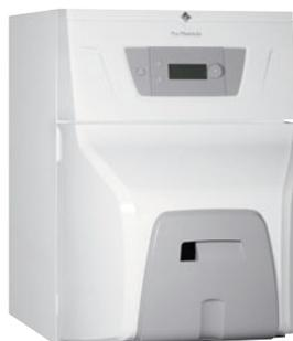
► Technologie : condensation ► Particulièrement compacte - Raccordement cheminée ou ventouse - Existe en version Basse Température ► Corps de chauffe principal en fonte eutectique - Échangeur-condenseur fumées en céramique/carbone ► Brûleur compact intégré compatible F30 - Flexible ventouse intégrée et raccordée au brûleur ► Tableau de commande E-Pilot connecté et intuitif
