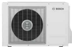
► T° ext. min. : -20°C ► T° ext. max. : 45°C ► T° de départ d'eau : 60°C ► Utilisation d'un fluide frigorigène à faible impact environnemental : R32 ► Étendue des puissances ► Gestion jusqu'à 4 circuits de chauffage ► Installation et entretien facilités : accès rapide aux alimentations et interface technicien
