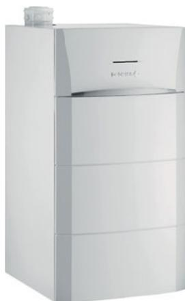
► Technologie : condensation ► Particulièrement compacte - Multi-circuits avec pré-équipement hydraulique intégrable ► Échangeur monobloc en acier inoxydable et porte foyer en aluminium ► Brûleur compact intégré compatible F30 - Modulant de 59 à 100% de la puissance ► Tableau de commande Diematic Evolution connecté et intuitif
