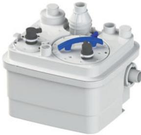
► Cuve en polypropylène renforcée fibre de verre ► Diamètre de tuyau de refoulement : DN 40 (Ø ext. 50 mm) ► Niveau ON/OFF : 140/70 mm ► Niveau d'alarme : 210 mm ► Boîtier déporté d'alarme filaire sonore et visuelle (5 m de câble) pour la version Sanicubic 1 WP
