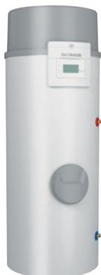
► Réchauffage de l'ECS par la PAC jusqu'à 65°C, COP à +7°C jusqu'à 3,48 ► Nouvel échangeur à très hautes performances : réduction du temps de charge ► Cuve vitrifiée protégée par anode à courant imposé ► Existe en variante H avec serpentin pour appoint hydraulique solaire ou chaudière ► Régulateur avec différents modes de fonctionnement
