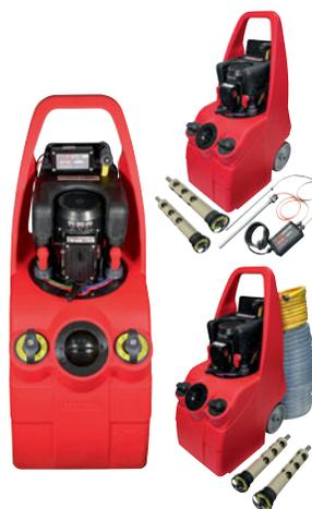
► Décroche et décolmate l'accumulation de boues en douceur sans risque de créer des bouchons ► Accélère et facilite le désembouage des installations de chauffage afin de restaurer la circulation ► Permet de nettoyer le corps de chauffe de la chaudière ou PAC ► Débit élevé pour un nettoyage facile et rapide : 90 L/min ► Inversion instantanée du flux - Tuyaux et raccords fournis
