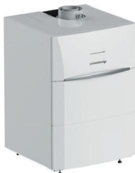
► Énergie: gaz naturel ou propane ► Corps de chauffe en acier inoxydable ► Modulation du brûleur de 1 à 9, compatible gaz vert et 20% hydrogène ► Largeur de 600 mm unique pour toute la gamme ► 3 modèles : à équiper avec kit séparateur 3 fonctions ou avec échangeur à plaques
