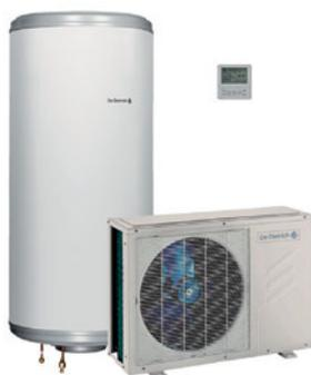
► À accumulation : composé d'un ballon et d'un module thermodynamique extérieur ► Ballon de 150 ou 200 L (mural) et de 200 ou 270 L (au sol) ► Réchauffage de l'ECS jusqu'à 65°C par la PAC - Fonctionnement de la PAC jusqu'à -15 °C ► Cuve vitrifiée, protection anode magnésium - Résistance électrique de secours 1.6/2.4 kW (mural/sol) ► Régulateur déporté pour programmation horaire, gestion de l'appoint, affichage des mesures et défaut
