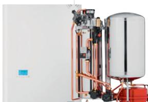
► Énergie: gaz naturel ou propane ► Production d'eau chaude inégalée : 280 et 450 L (ex à 20 L/min 40 °C avec apport eau froide à 15 °C) ► Brûleur modulant à contrôle air/gaz et très bas taux NOx Classe 6 ► Régulation Ecoradiosystem Visio® pour la gestion jusqu'à 3 circuits chauffage indépendants ► Corps de chauffe optimal à rendement élevé : jusqu'à 109 % sur PCI - Rendement saisonnier 95 % sur PCS
